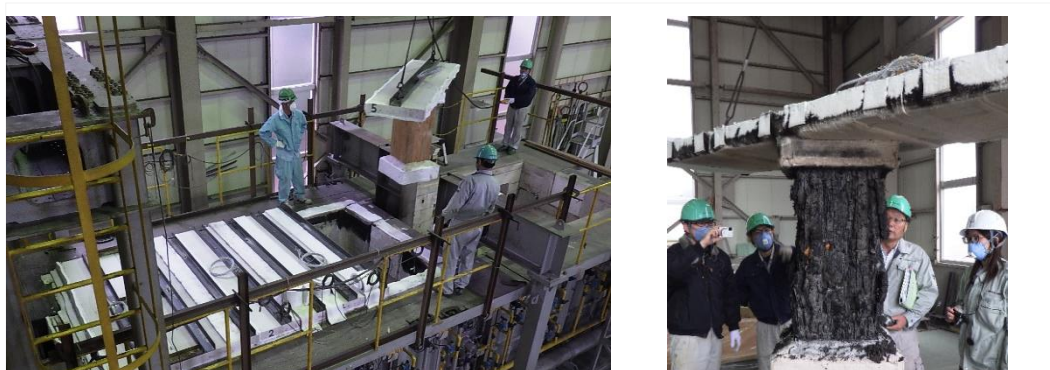
写真 2.1 燃え止まり型の耐火集成材の耐火性能試験の様子
