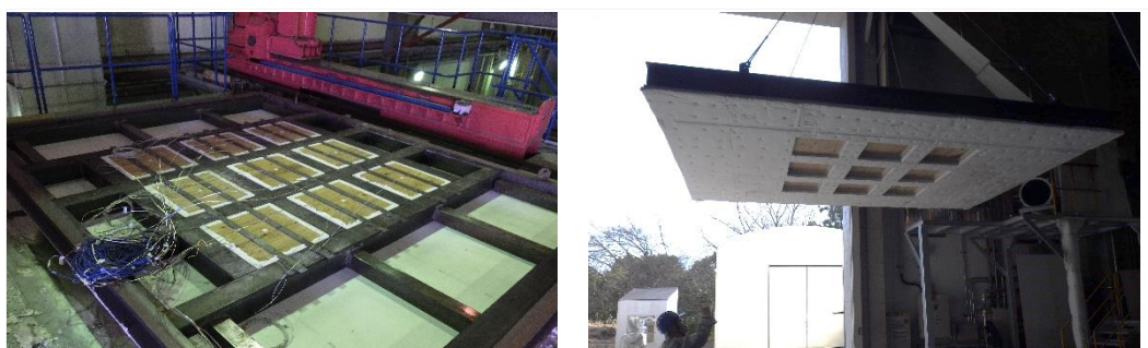
写真 2.2 燃え止まり層の性能試験の様子
