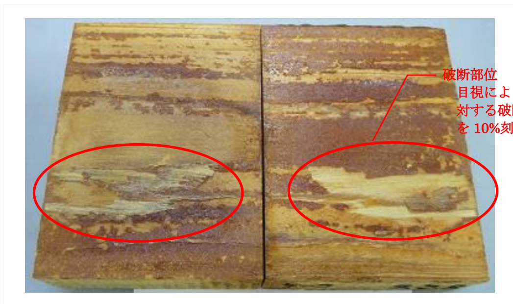
図 5.2 ナイフテストの概要 (TW-29/D 用硬化剤 (圧縮圧力 0.01MPa) の試験片)
