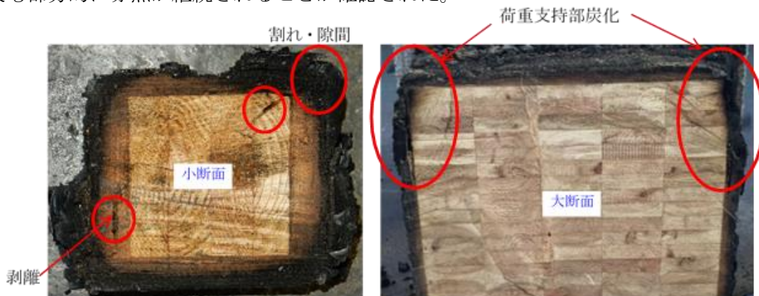
写真 3.1-1 加熱試験後の試験体断面
