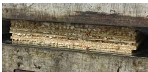
写真 5.2.4.2-1 熱圧中の木口の様子（左：D-17S、右：D-98、熱圧温度 120℃）
