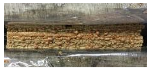
写真 5.2.4.2-2 熱圧中の木口の様子（左：D-17S、右：D-98、熱圧温度 140℃）
