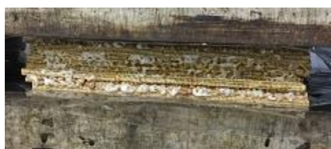
写真 5.2.4.2-2 熱圧中の木口の様子（左：D-17S、右：D-98、熱圧温度 140℃）
