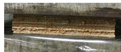
写真 5.2.4.2-3 熱圧中の木口の様子（左：D-17S、右：D-98、熱圧温度 160℃）
