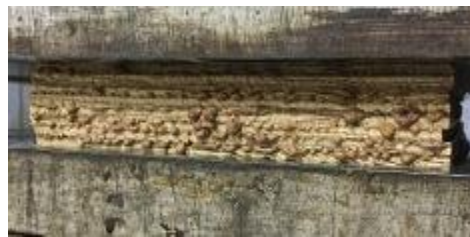
写真 5.2.4.2-1 熱圧中の木口の様子（左：D-17S、右：D-98、熱圧温度 120℃）
