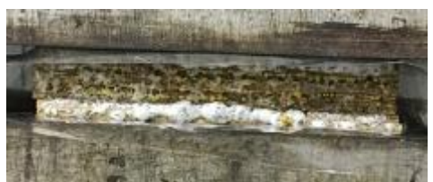
写真 5.2.4.2-3 熱圧中の木口の様子（左：D-17S、右：D-98、熱圧温度 160℃）
