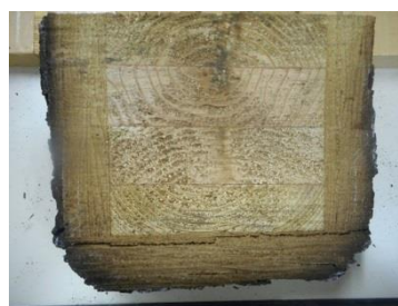
写真 3.4-2 難燃処理 LVL の接着不良
