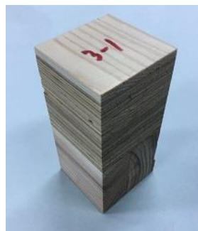
写真 5.2.2.1.2.2-1 ブロックせん断試験片 (左) およびナイフテスト試験片 (右)
