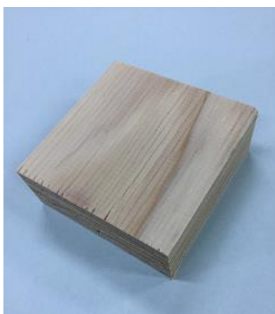
写真 5.2.1.1.3-1 小口シール済みホルムアルデヒド放散量測定用試験片（右） および剥離試験片（左）
