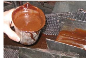
図 6. 2. 4. 1-1 循環糊粘度計測の様子
