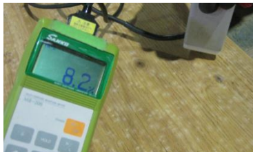
図 6.2.2-2 電気式含水率計による測定値
