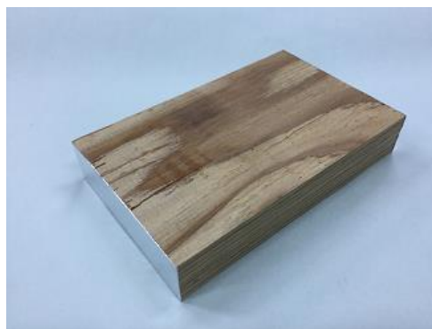
写真 5.2.1.1.3-1 小口シール済みホルムアルデヒド放散量測定用試験片 (右) および剥離試験片 (左)
