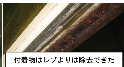
図 6.2.3.2-7 フェノ使用 中の熱板(黒い付着物)
