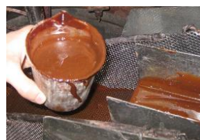
図 6.2.4.1-1 循環糊粘度計測の様子
