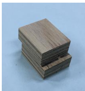
写真 5.2.2.1.2.2-1 ブロックせん断試験片(左)およびナイフテスト試験片(右)
