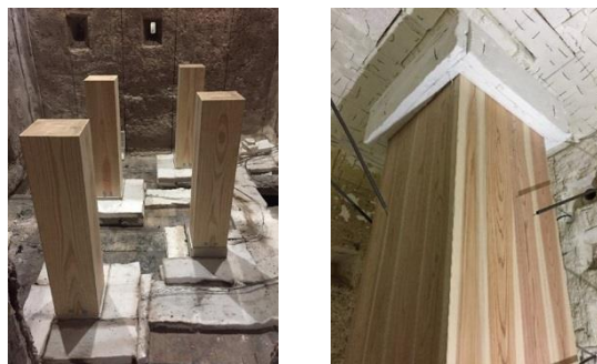
写真 2.2-1 各耐火性能試験における試験体の様子
